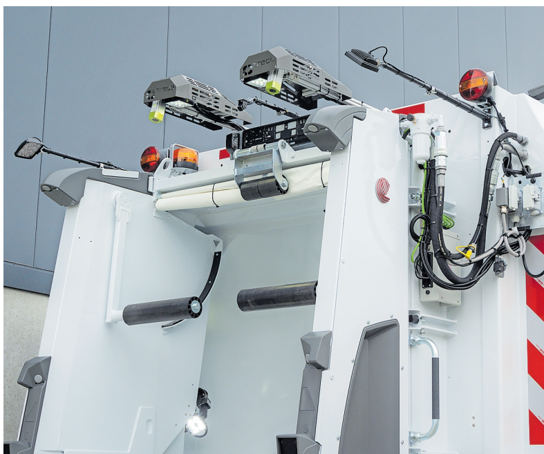
Intelligentes Kamerasystem: Dank der neu verbauten KI können BioEnergieTonnen ohne zusätzlichen Aufwand auf Störstoffe kontrolliert werden. Foto: © c-trace GmbH
