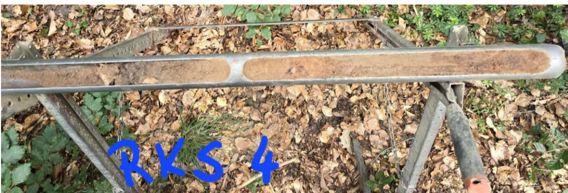
Abbildung 7: WEA 1: Kleinrammbohrung RKS 4
