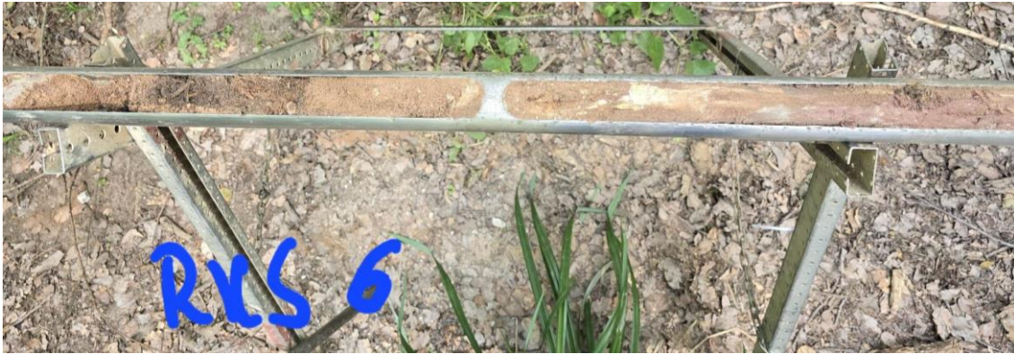
Abbildung 8: WEA 1: Kleinrammbohrung RKS 6
