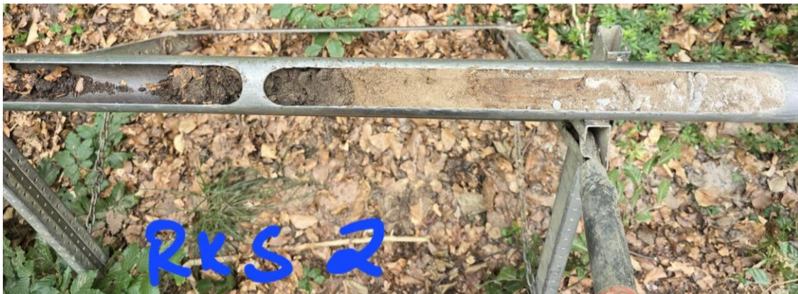
Abbildung 6: WEA 1: Kleinrammbohrung RKS 2
