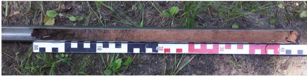
Abbildung 5: WEA 1: Pürckhauer – Handbohrung S4; „k115“- Braunerde aus sandiger Fließerde aus Stubensandstein
