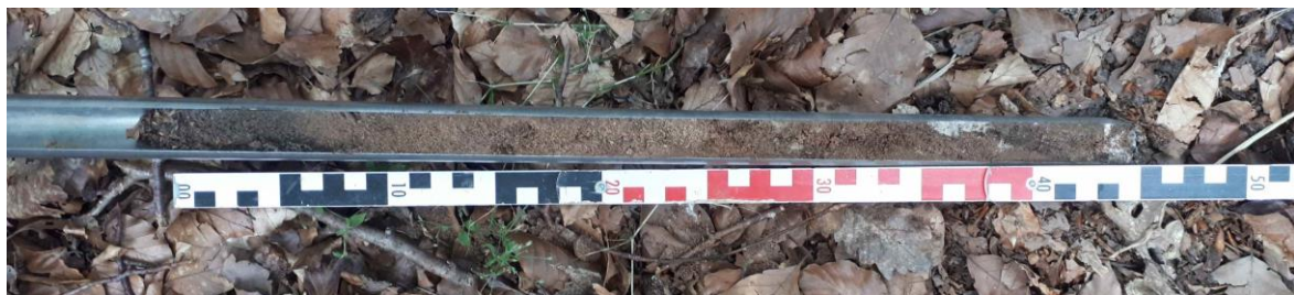
Abbildung 2: WEA 1: Pürckhauer – Handbohrung S1; „k115“- Braunerde aus sandiger Fließerde aus Stubensandstein
