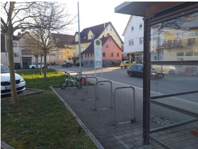
Abbildung 25: Abstellanlage ohne Überdachung, Anlehnbügel (Kupferzell, Untere Vorstadt)
