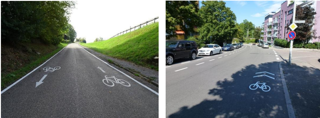
Abbildung 11: Piktogrammketten außerorts in Backnang (links) und innerorts in Heilbronn (rechts)
